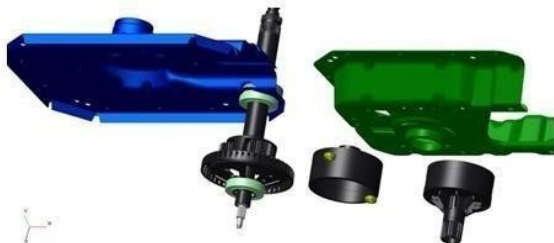
Transmisión con Speed Wheel (Rin para sensor)
