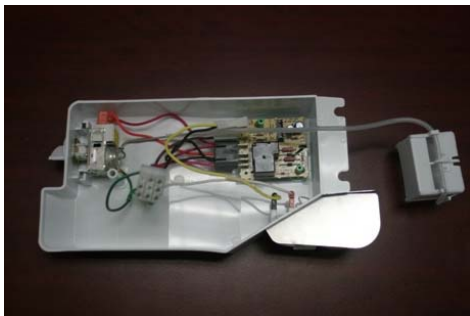
Ensamble caja control mecánica 2266767 (Ctrl. Box Assy ADC)
