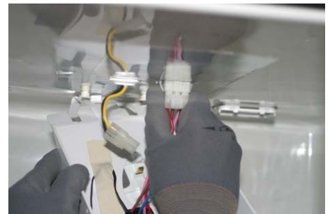
Retire el conector colocado en el liner y retire la caja de control.
